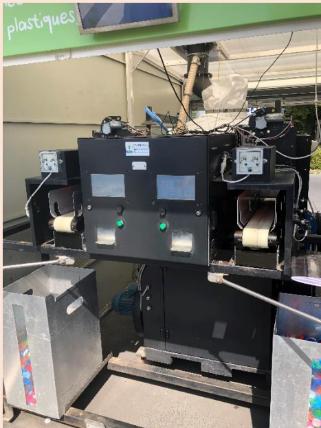
Les bouteilles sont broyées en paillettes qui tombent dans le bac noir du dessous
