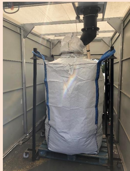
Les paillettes du bac noir sont soufflées vers le big-bag sur palette, qui contient 12.000 bouteilles broyées !
